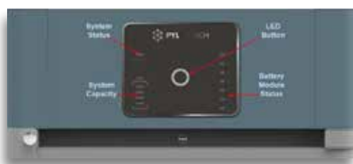
Display del BMS
